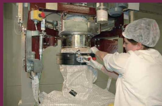
Befestigung am Füllstutzen mit Blähmanschette für die Abdichtung des Großsackes während der Befüllung
