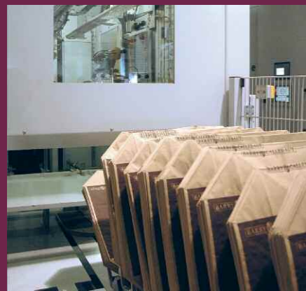
Leersack-Zuführung zum Aufstecker aus dem Leersack-Zellenband
