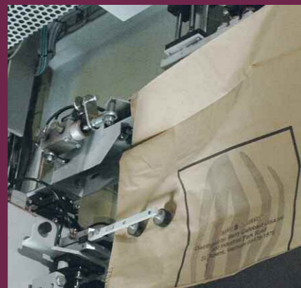
Kontrollierte Ventilöffnung für die optimale automatische Sackaufsteckung
