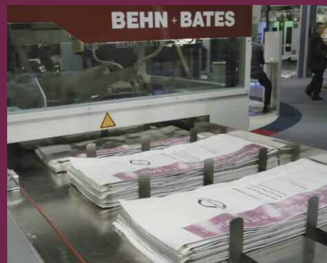
Bedarfsgerecht: Das Leersackmagazin (maximale Speicherkapazität: 500 Säcke)
