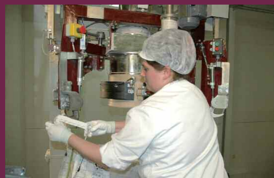
Einhängen der Großsack-Schlaufen in die schwenkbaren Haken
