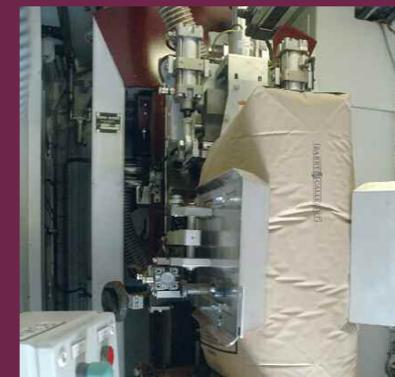
Ventilsack-Verschließung mittels Ultraschall direkt am Füllstutzen
