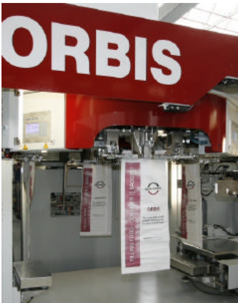
Bildtext: Innenansicht des ORBIS mit Drehteller für 4 Füllstutzen
